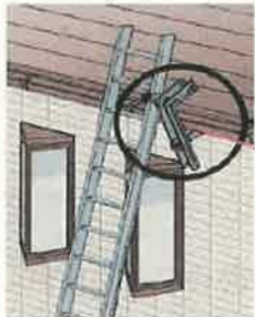
雪止めアンクル梁にパイプや固定金具を利用して支柱固定 スタンション・親綱支柱による親綱の設置例
